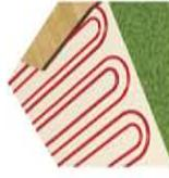
Riscaldamento a pavimento con bassa temperatura
