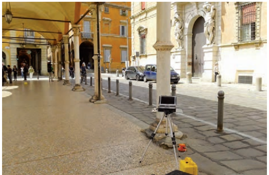
Misure di vibrazioni centro storico di Bologna su monumenti storici di elevata sensibilità
