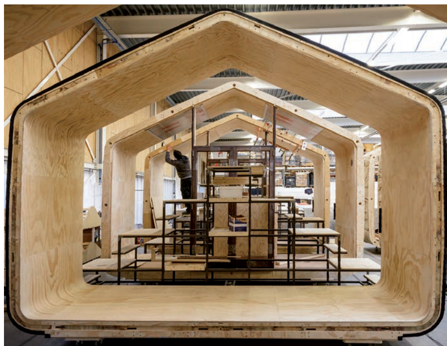
In alto e a destra: alcune fasi della produzione, trasporto e montaggio della Wickelhouse. Il facile assemblaggio, la leggerezza e il design sono le peculiarità che rendono unica questa soluzione. Sotto: la sezione del multistrato di cartone usato per la costruzione
